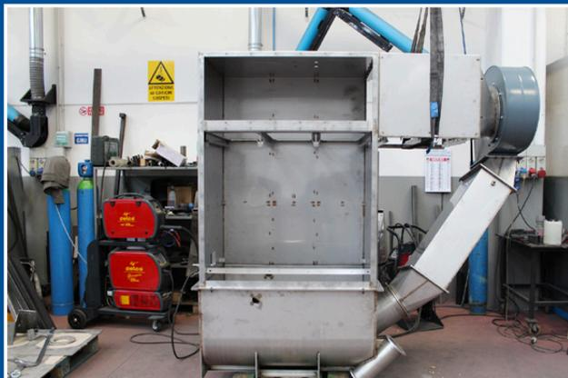
Struttura in inox 304 pre-assemblata pronta alla saldatura in opera
