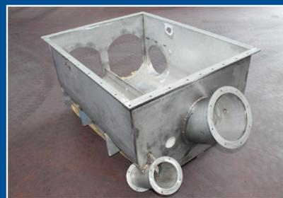
Vasca in inox 304 saldata a tenuta con i vari tubi di carico/scarico
