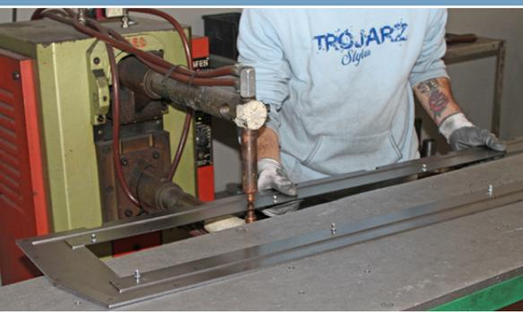
Puntatura elettrica sul ferro spessore 2 + 2 mm
